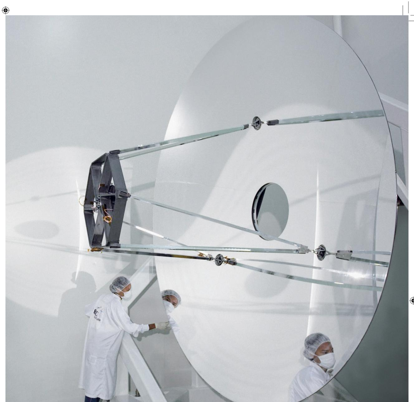
**Herschel-Teleskop** // Nach seinem für 2008 geplanten Start wird das bisher größte Weltraumteleskop 1,5 Millionen Kilometer von der Erde entfernt positioniert – etwa fünfmal so weit wie der Mond. Von dort aus soll es Erkenntnisse über die Entstehung und Entwicklung von Milliarden Lichtjahre entfernten Sternen und Galaxien liefern. Das Teleskop mit einem Durchmesser von 3,5 Metern ist das erste Weltraumobservatorium, das den gesamten Ferninfrarot- und Submillimeter-Wellenlängenbereich abdeckt.
