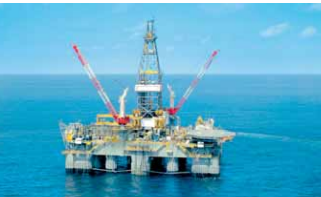
Mit dem HCI Deepsea Oil Explorer sind Bohrungen bis zu einer Meerestiefe von 2.400 Metern möglich.
