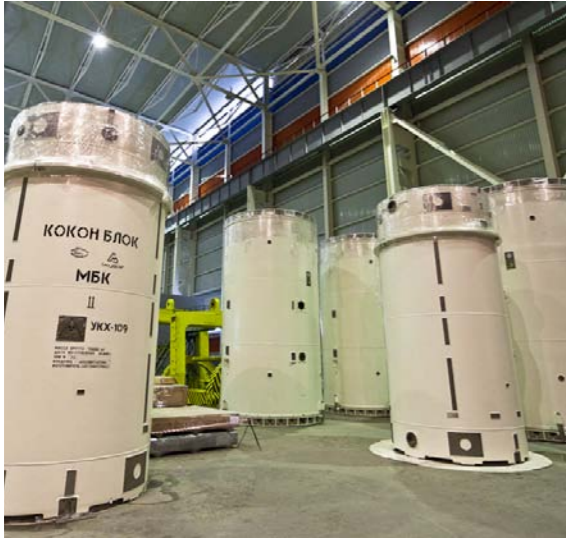
Dry containers and water pool SNF storage (Kursk NPP)
